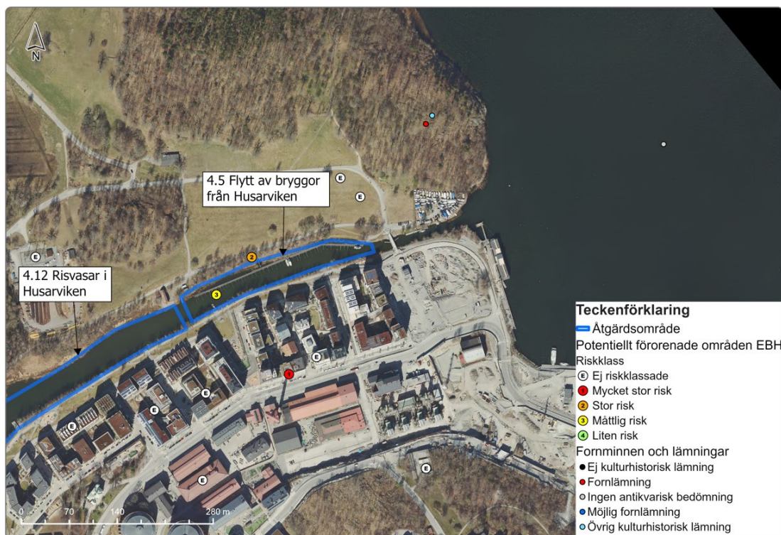
Figur 11. Åtgärdens föreslagna utbredning i Husarviken samt kulturhistoriska lämningar och potentiella föroreningar i området.
