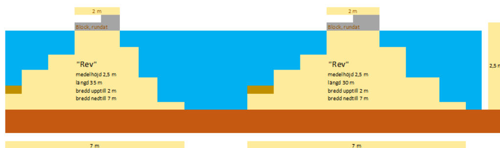
Figur 4. Schematisk bild med uppskattade mått på "medelutformningen" av reven. Tanken är att reven ska ha en mycket varierande form, bredd och höjd i verkligheten. Sjökortet anger ett djup under tre meter, men en kartering av botten och förekommande naturvärden behöver göras innan åtgärder projekteras.
